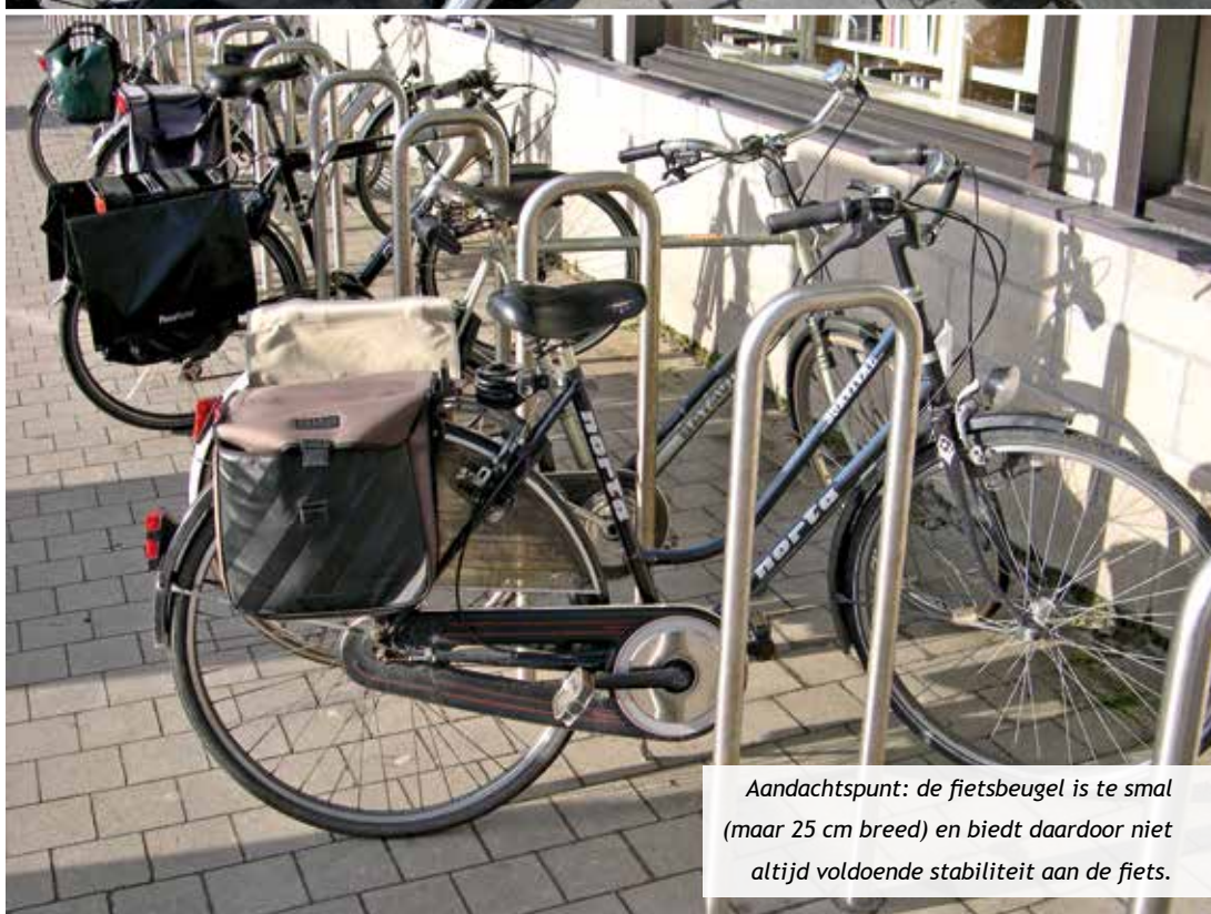
Fietsen kunnen met het frame en de wielen aan de stalling bevestigd worden.
