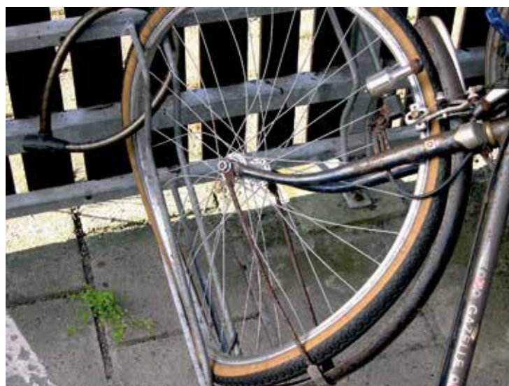
Wielklemmen verkleinen het risico op diefstal niet. Ze beschadigen de fiets daarentegen. Het Vademecum Fietsvoorzieningen keurt wielklemmen daarom volstrekt af.
